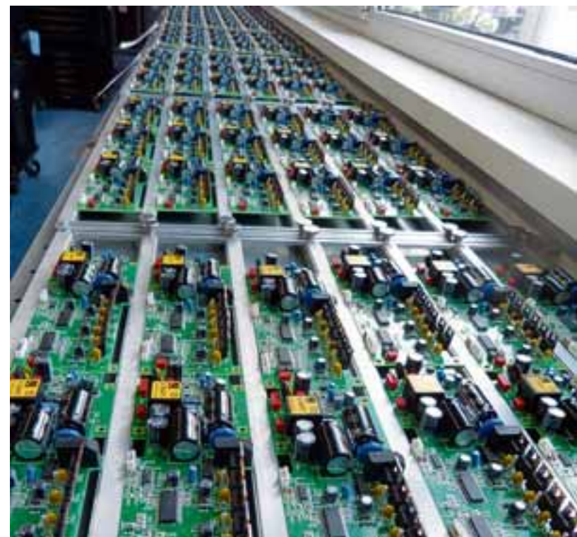
1300 verschiedene Leiterplatten sind derzeit bei Matulka in Arbeit, teils in Großauf­lage wie im Bild, teils in kleiner Stückzahl.
